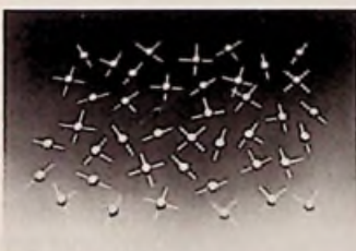
Bild 1: Beam-Lead-Schottky-Dioden für Frequenzen bis 26 GHz (Hewlett-Packard-Pressbild)
