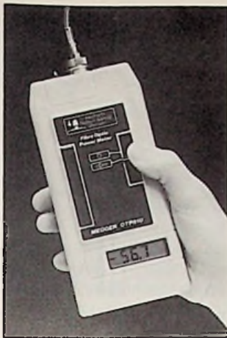
Bild 1: Mißt die Eigenschaften von Lichtwellenleitern (Thorn-EMI-Pressbild)
