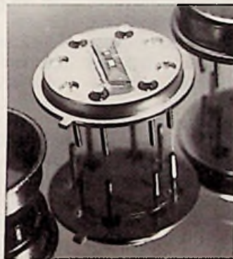
Bild 1: OFW-Filter im Metallgehäuse für den Freilufteinsatz an der Satelliten-Empfangsantenne (Siemens-Pressbild)
