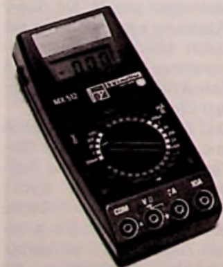
Bild 1: Digitales Handmultimeter für alle Zwecke (Zeheter-Pressebild)
