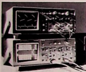
Bild 1: 20-MHz-Zweikanaloszilloskope der Low-cost-Klasse (Siemens-Pressebild)
